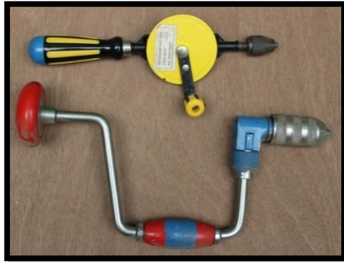
Gambar 6.4. Bor Tangan pada Pekerjaan Konstruksi Kayu
