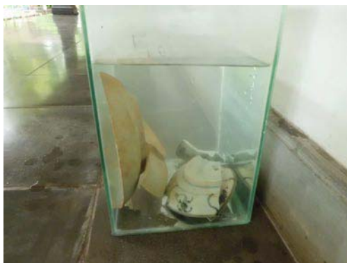
Gambar 21. Sambungan akan terlepas ketika direndam dalam air
