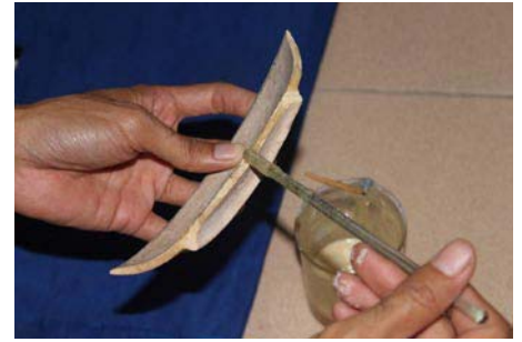
Gambar 4. Proses penyambungan dengan animal glue
