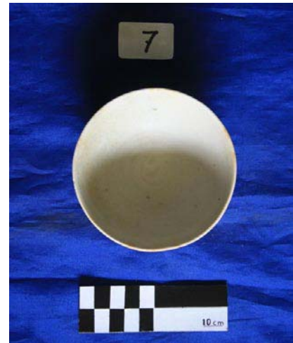
Gambar 10. Kondisi keramik setelah dibersihkan dengan HCl 5 %
