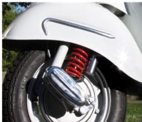
Gambar 3. Konstruksi suspensi trailing link
