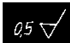
Gambar 135. Kelebihan ukuran untuk proses lanjutan
