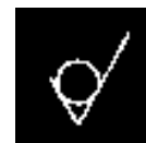
Gambar 129. Tanda pengerjaan tanpa penyayatan
