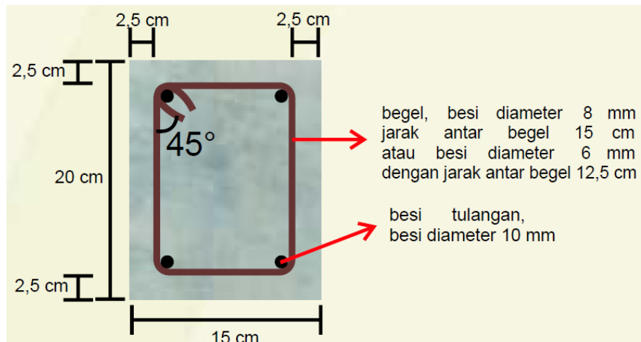
Gambar 5. 10 Pembuatan begel sloof
