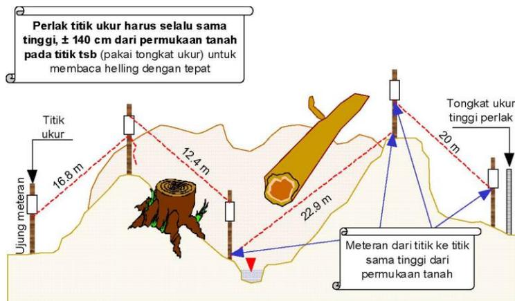
**Gambar 9. Pengukuran jarak lapangan**
