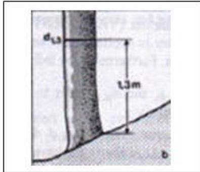
**Gambar 7. Mengukur diameter yang tumbuh di tempat miring**
