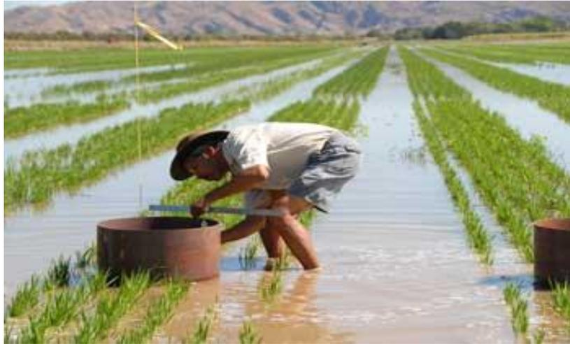
**Gambar 38. Pengukuran Laju Permeabilitas**
