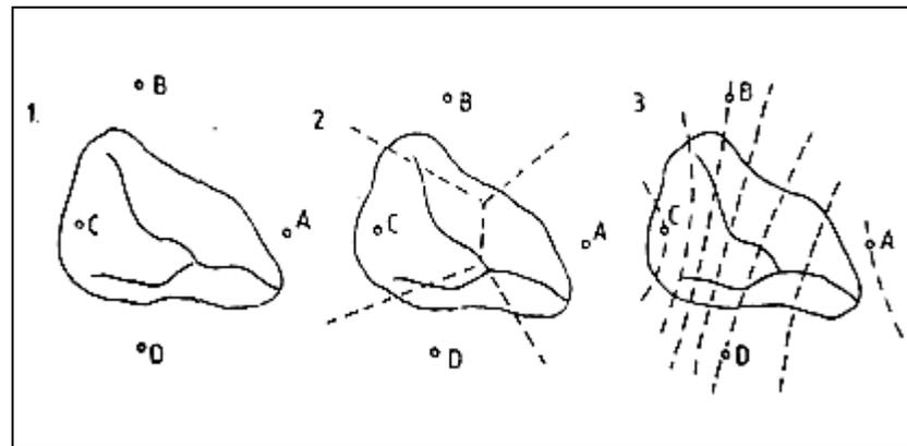
**Gambar 23. Ilustrasi pengukuran curah dengan cara isohyet**
