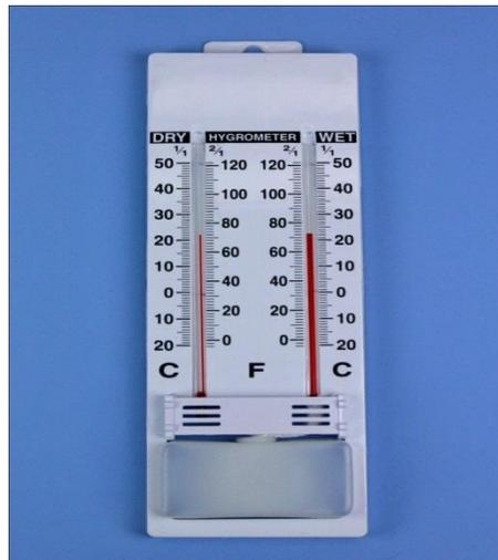
**Gambar 45. Termometer bola kering dan bola basah**
