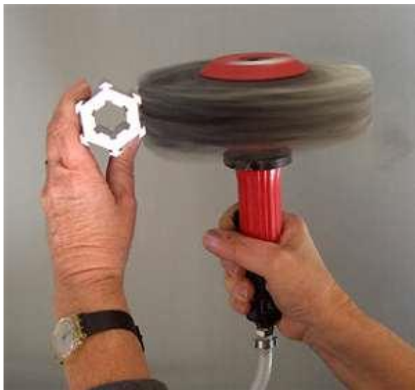
Gambar 6.24 Cara menggunakan gerinda
