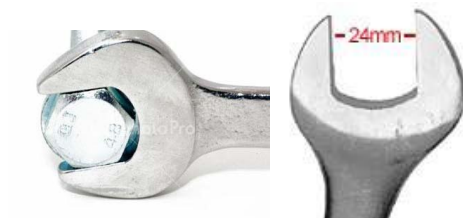
Gambar 4.22 Cara menggunakan kunci pas
