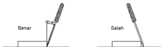
Gambar 4.8. Cara arah menggores benda kerja
