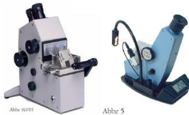
Gambar 6. Dua jenis Refraktometer Abbe yang modern (tipe Abbe 60/95 dan Abbe 5)
