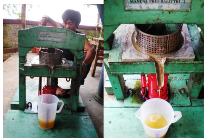
Gambar 5. 4 Pengepresan biji menggunakan dongkrak hidrolik
