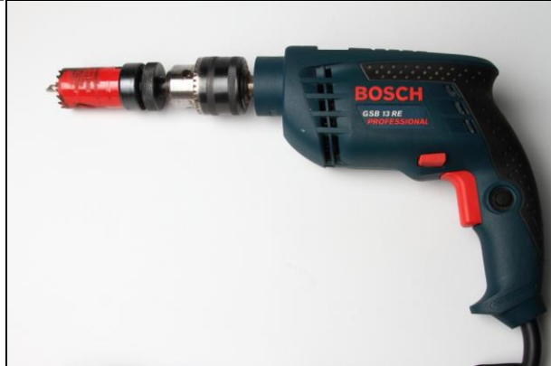
Gambar 2. 50 Pemboran lubang tembus
