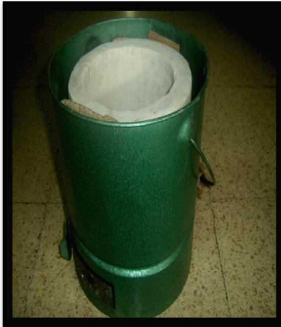
Kompor Biobriket tersebut digunakan untuk pengujian kalor dan kadar abu biobriket. Spesifikasinya adalah: kompor berukuran diameter 20 cm, tinggi 22 cm, di dalamnya dilengkapi dengan batu tahan api dengan ketebalan 2 cm, diameter dalam 11,5 cm dan tinggi 12 cm, dan kapasitas 1 kg untuk 6 jam pembakaran.
