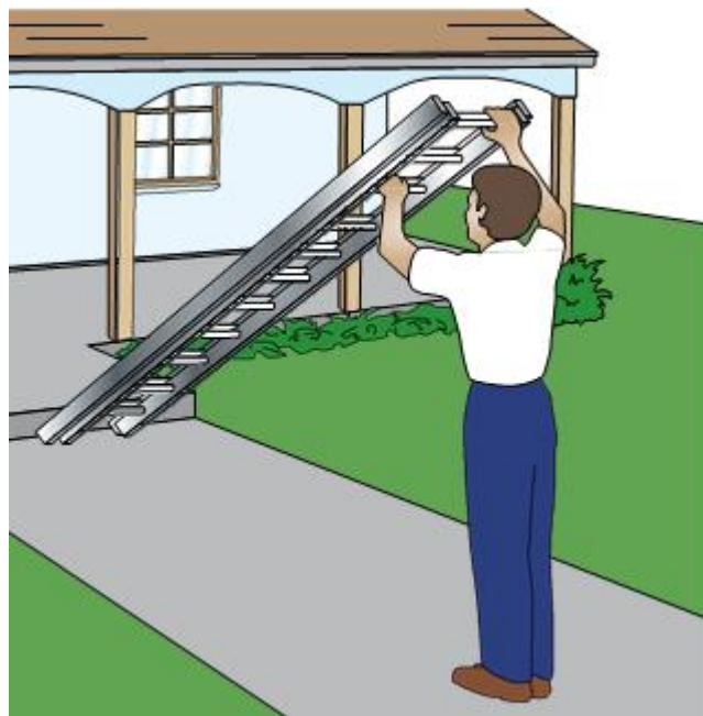
Gambar 8. 9 Cara Menaikkan Tangga Ekstensi Atau Tangga Lurus (www.g-w.com)
