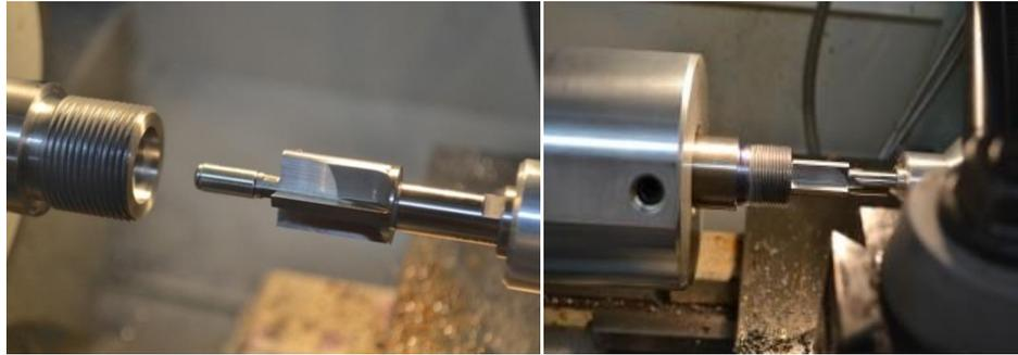
**Gambar 43 Contoh Pemasangan Konter Bortangkai Tirus dan Penggunaannya pada Mesin Bubut**
