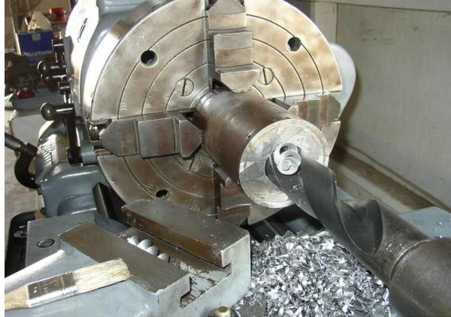
**Gambar 22 Pengikatan Mata Bor Tangkai Tirus pada Kepala Lepas, Saat Melakukan Pengeboran pada Mesin Bubut**
