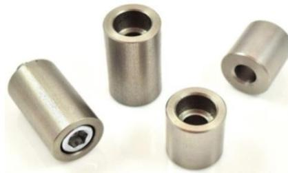
**Gambar 44 Contoh Hasil Pembubutan Lubang Bertingkat dengan Konterbor**
