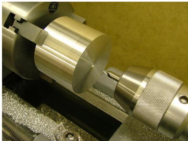
**Gambar 18 Contoh Pengikatan Senter Bor pada Cekam Bor untuk Proses Pembubutan**
