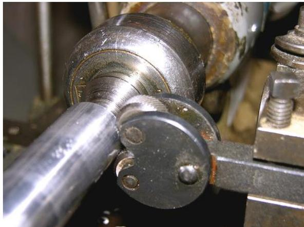
**Gambar 58 Pengikatan/ Pemasangan Kartel Pada Tool Post Mesin Bubut**
