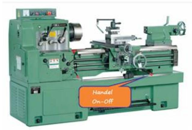
**Gambar 110 Contoh Posisi Handel/Tuas On-Off Mesin Bubut Standar**
