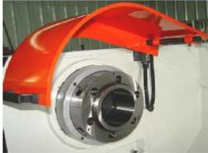
**Gambar 2. Kepala Tetap, Tampak Spindel Utama Mesin**
