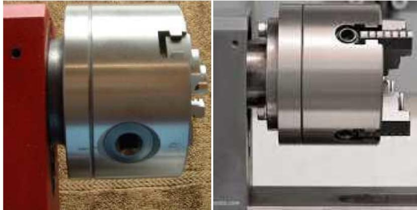
**Gambar 21. Contoh Cekam Sepusat dan Tidak Sepusat Terpasang Pada Spindle Mesin**
