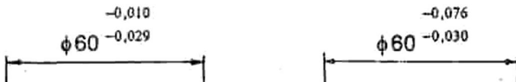
Gambar 57. Penulisan Toleransi Ukuran Nominal dan Penyimpangannya
