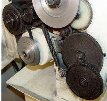
**Gambar 4. Sistem Penggerak dan Pengatur Putaran Mesin/Kecepatan Pemakan dengan Roda Pully dan Sabuk V**
