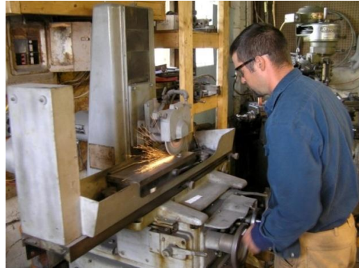
Gambar 90. Berbagai proses penggerindaan dengan mesin gerinda datar
