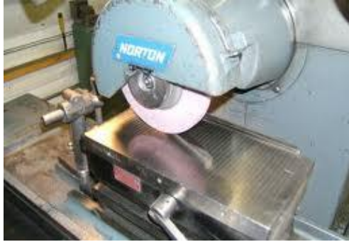
Gambar 125. Penggerindaan permukaannya meja magnet
