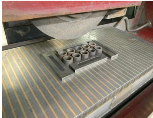
Gambar 127. Pengikatan benda kerja yang memiliki ukuran relatif kecil dengan meja magnet
