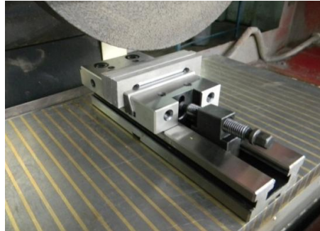
Gambar 130. Pengikatan benda kerja yang memiliki ukuran relatif pendek
