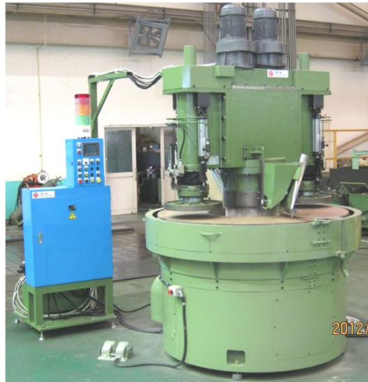
Gambar 12. Mesin gerinda datar posisi spindel vertical dengan gerak meja berputar (spindel mesin dua buah)
