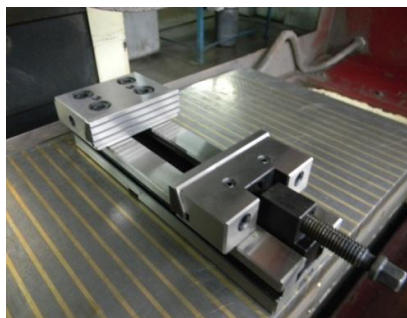
Gambar 129. Kondisi ragum presisi harus bersih
