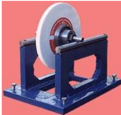
Gambar 112. Penempatan arbor pada dudukan peyetimbang
