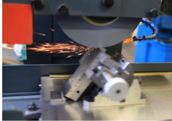
Gambar 144. Penggerindaan bidang miring dengan ragum sudut universal presisi
