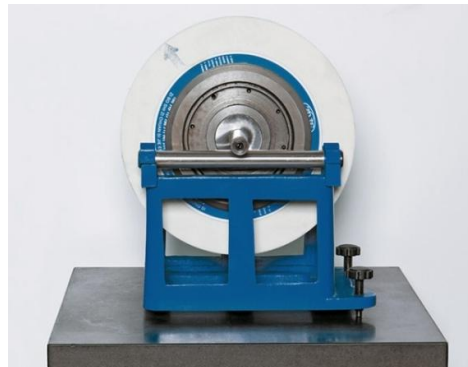
Gambar 120. Posisi roda gerinda setimbang
