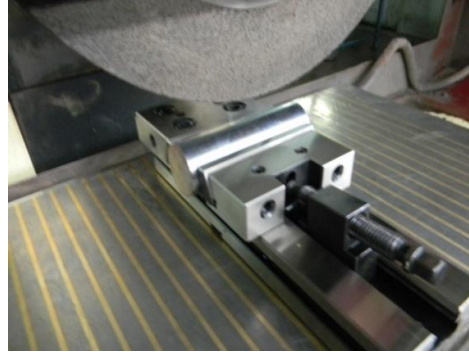
Gambar 132. Pengikatan benda kerja yang memiliki bentuk atau profil bulat
