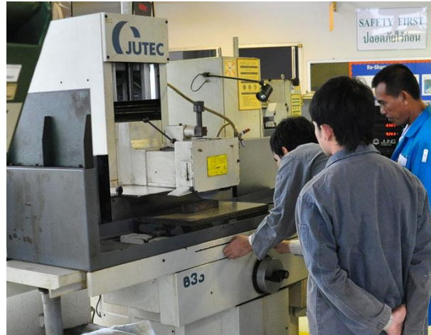
Gambar 152. Berkerumunan disekirtar mesin gerinda datar yang sedang dioperasikan, tanpa menggunakan alat pelindung keselamatan kerja
