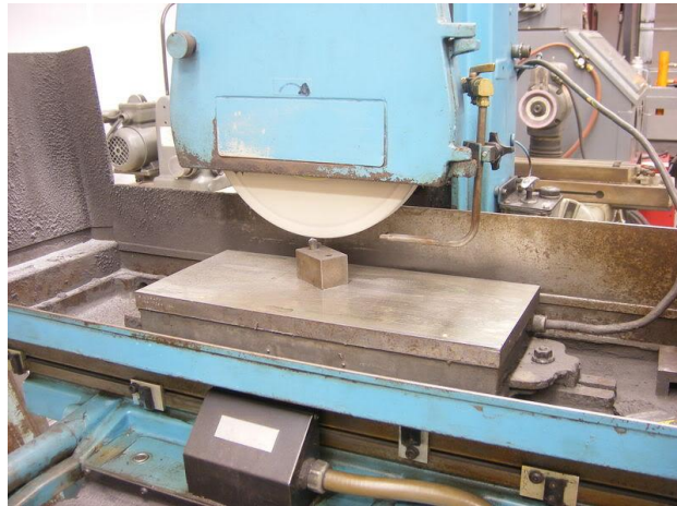
Gambar 97. Pengasahan/dresing roda gerinda
