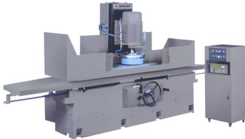
Gambar 8. Mesin Gerinda datar posisi spindel vertikal dengan gerak meja bolak-balik
