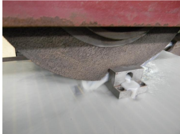
Gambar 145. Penggerindaan alur/profil dengan meja magnet
