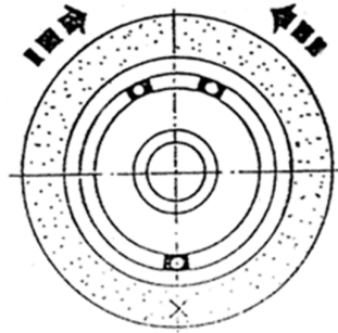
Gambar 119. Mengatur bobot peyetimbang
