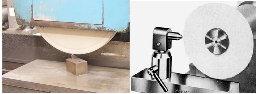
Gambar 92 Hasil pembentukan roda gerinda bentuk rata dengan pemegang dreser bentuk standar
