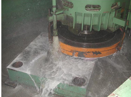
Gambar 7. Prinsip kerja mesin gerinda datar spindel vertikal dengan gerak meja bolak-balik
