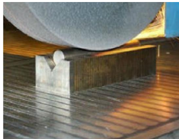
Gambar 133. Pengikatan benda kerja dengan balok penghantar magnet alur V
