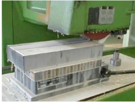
Gambar 136. Penggunaan media pendingin pada proses penggerindaan datar
