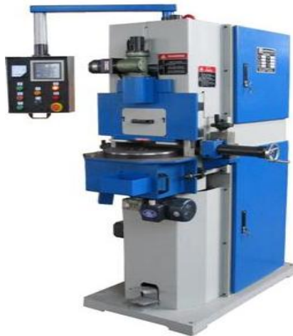
Gambar 10. Mesin gerinda datar posisi spindel vertical dengan gerak meja berputar (kolom mesin satu buah)
