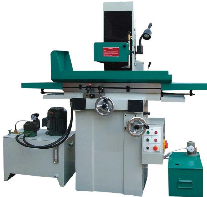
Gambar 14. Mesin gerinda datar semi otomatis
