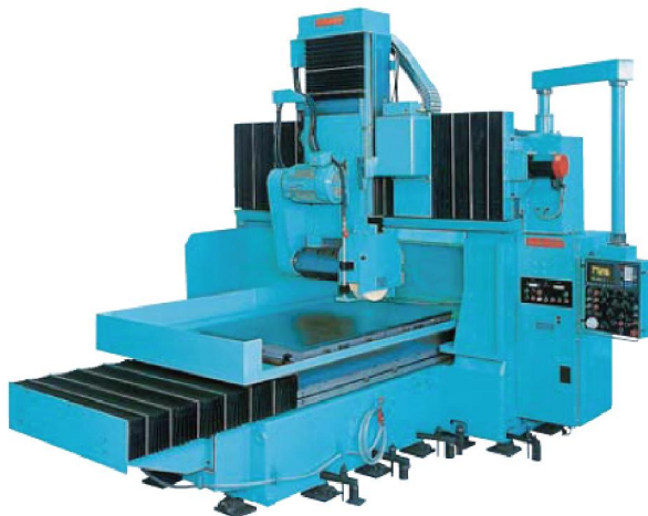
Gambar 4. Mesin gerinda datar spindel horizontal dengan gerak meja bolak-balik (kolom mesin dua buah)
