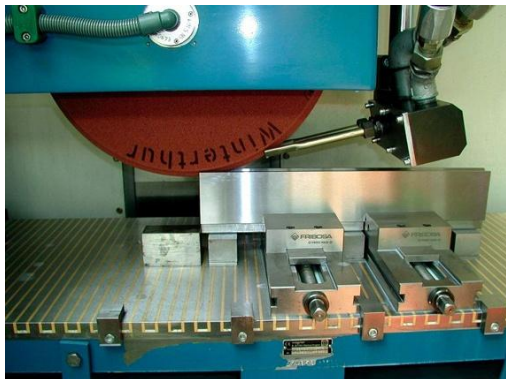
Gambar 131. Pengikatan benda kerja berukuran relatif panjang
