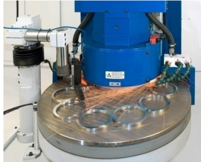
Gambar 9. Prinsip kerja mesin gerinda datar spindel vertical dengan gerak meja berputar
