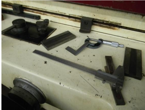
Gambar 150. Penempatan peralatan kerja yang tidak aman
