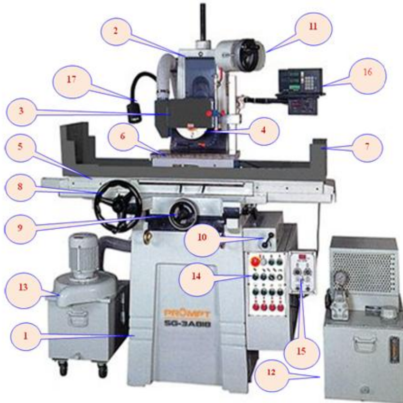
Gambar 17. Mesin Gerinda datar spindel horizontal
