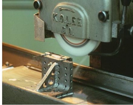
Gambar 134. Pengikatan benda kerja dengan balok penyiku
