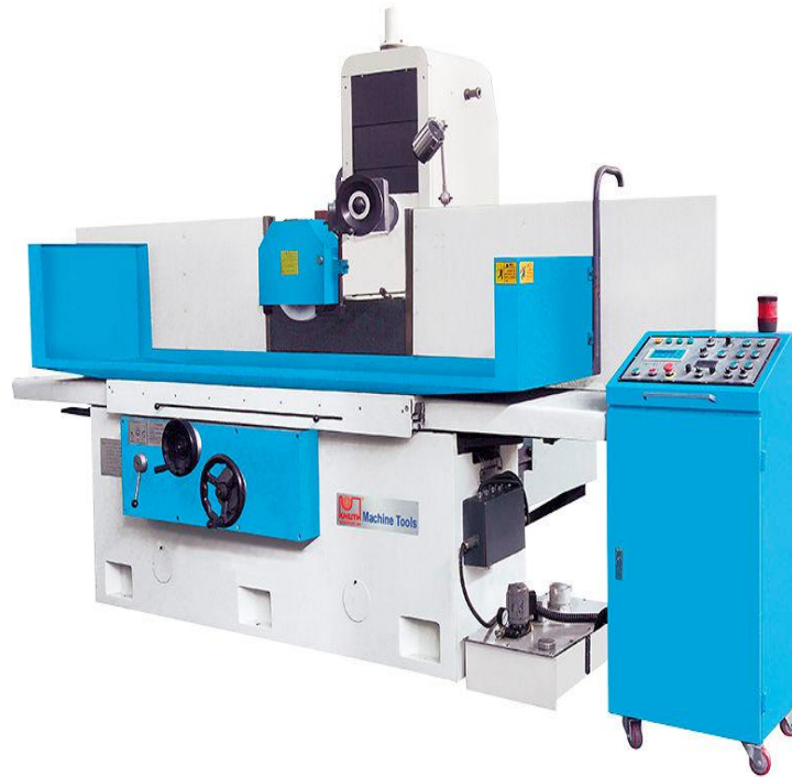
Gambar 15. Mesin gerinda datar otomatis
