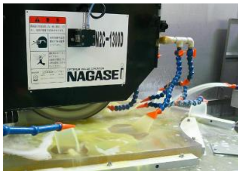
Gambar 137. Posisi nozzle harus dapat diatur dengan mudah
