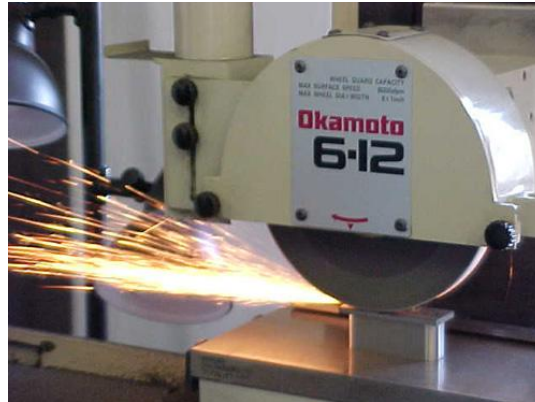
Gambar 2. Prinsip kerja mesin gerinda datar spindle horizontal dengan gerak meja bolak balik
