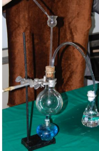
Gambar 3.9 Perangkat pembuatan gas CO 2
