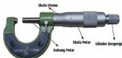
Gambar 31. Bagian-bagian micrometer sekrup
