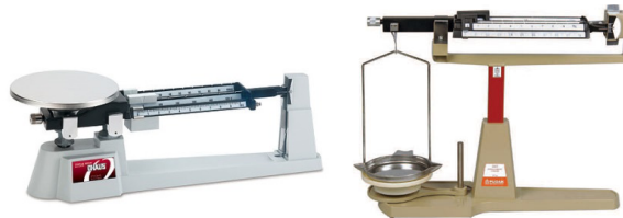
Gambar 34. Neraca teknis tiga lengan
