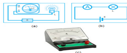
Gambar 42. Mengukur Arus Listrik dengan Menggunakan Amperemeter Sumber : http://mafia.mafiaol.com/2013/04/cara-mengukur-pengukuran-kuat-arus.html
