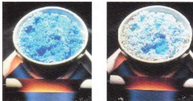
Gambar 47. Pemanasan  $\text{CuSO}_4 \cdot 5\text{H}_2\text{O}$  yang berwarna biru menjadi abu-abu.
