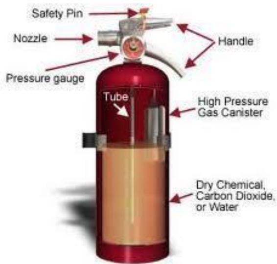
Gambar 7.4. Bagian-bagian alat pemadam kebakaran
