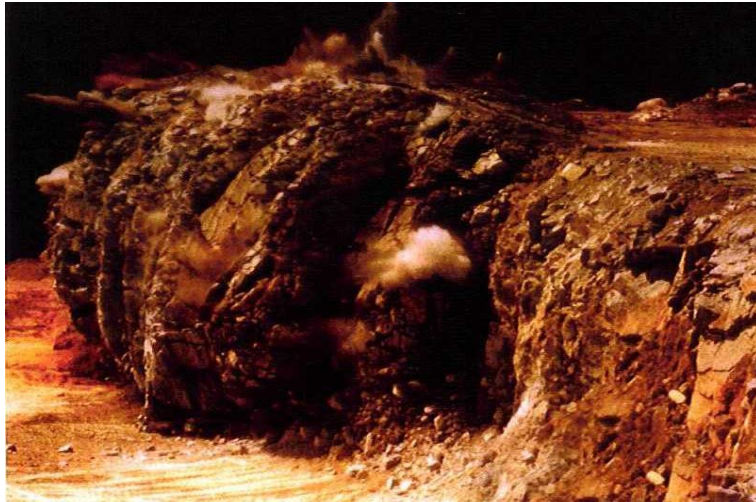
Gambar 4.4 Gerakan batuan akibat tekanan gas hasil peledakan
