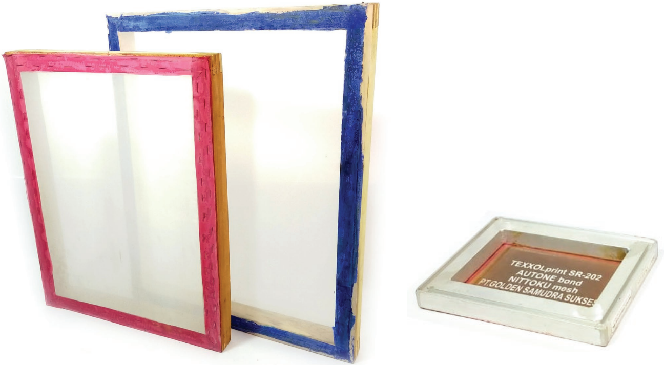
Kain Kasa yang telah terpasang pada bingkai sablon
