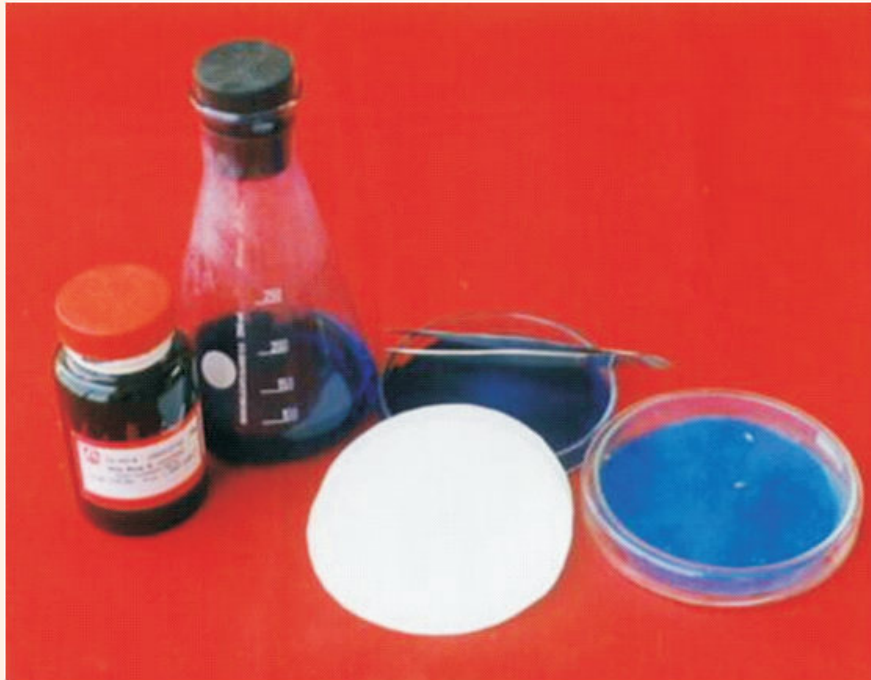
Gambar 34. Bahan penanda Nile blue A (a), larutan Nile blue A (b), kertas saring Whatman (c), dan kertas saring yang telah diwarnai dengan larutan Nile Blue (d)
