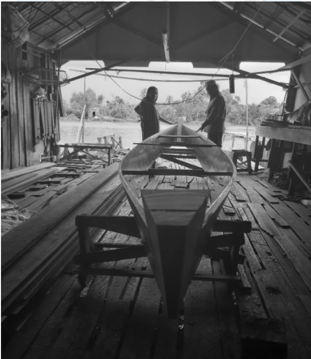
Gambar 4.1 Pembuatan perahu jukung di Desa Lok Baintan
