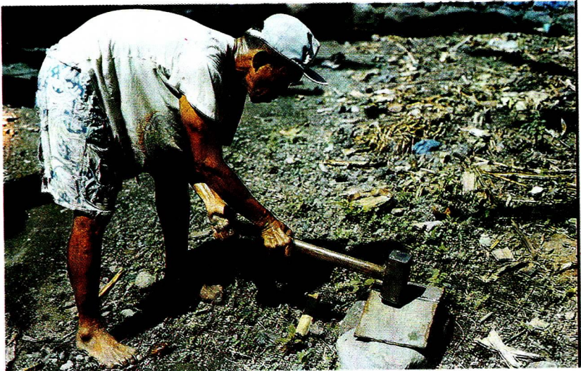
5. Cara memotong besi untuk keris
