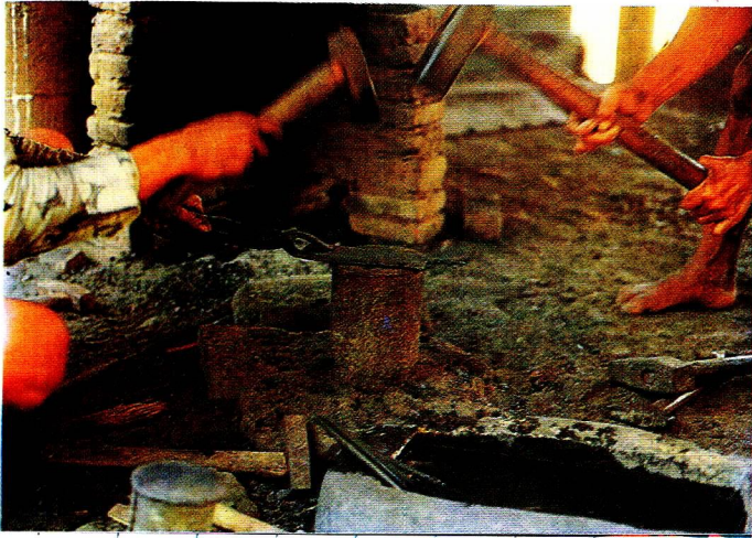
11. Pande Mangku Made Wija dan pembantunya sedang memukul besi tua yang akan dijadikan keris
