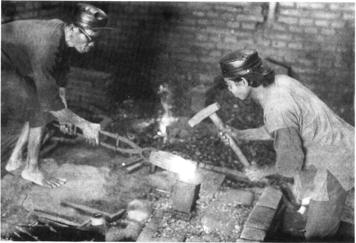
Seorang panjak sedang menempa bahan untuk membuat keris di "besalen" sedang Empu menjepit bahan tersebut.
