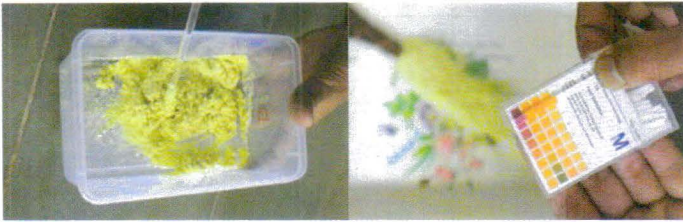
Foto 3.2.44. Campuran sulfur, garam, dan air serta pengukuran pH
