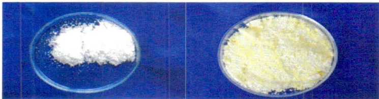
Foto 3.2.43. Garam dan sulfur yang digunakan dalam proses pembersihan karat
