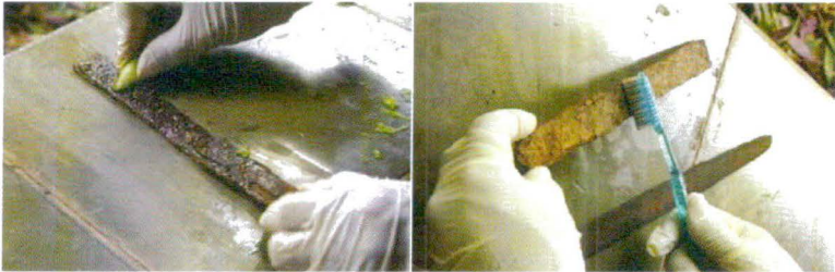
Foto 3.2.25. Proses pembersihan karat menggunakan belimbing wuluh
