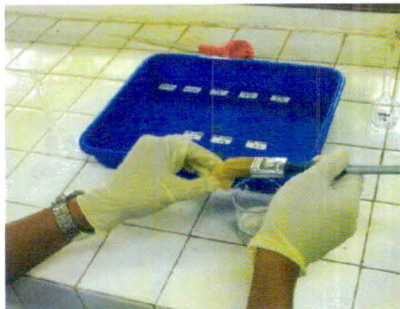
Gambar 6.1.7. Pengolesan minyak atsiri pada permukaan kayu
