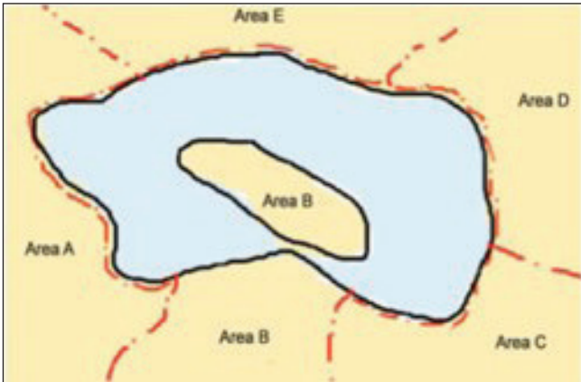
Gambar 3.3. kondisi garis batas di mana seluruh danau/kaldera masuk ke salah satu wilayah (Sumber: Peraturan BIG No. 12 Tahun 2017)
