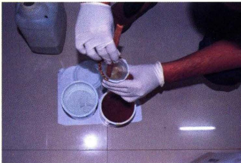
Gambar 8. Pencampuran bahan perekat dan larutan paraloid 2%
