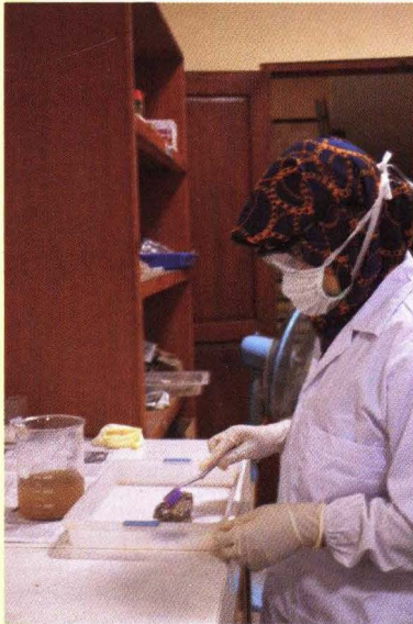
Gambar 13. Proses pembersihan kimiawi
