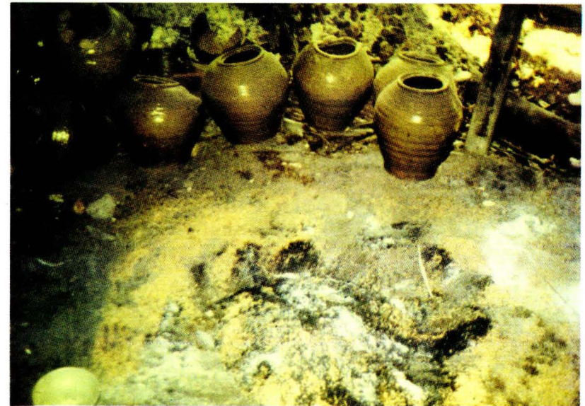
22. Pembakaran sekam padi dan kulit kerang untuk bahan glasir Burning of rice husk and mollusc shell for glaze material
