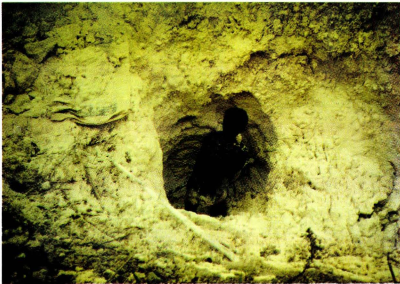
21. Pengambilan tanah kaoling sebagai bahan glasir Quarry of kaolin raw material for glaze
