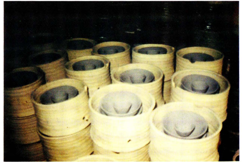
38. Keramik berukuran kecil waktu pembakaran dimasukkan ke dalam wadah, supaya tidak pecah. Small sized goods are placed in a container to prevent breaking during firing
