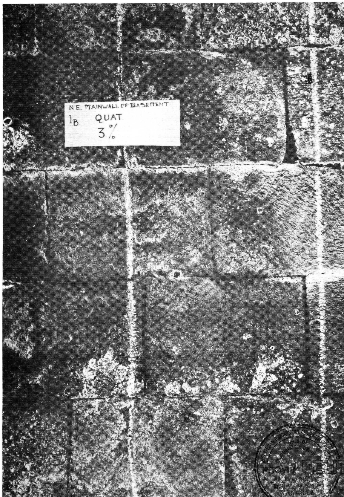
21. Percobaan membersihkan batu dengan bahan kimia. Foto ProBo 7709.
