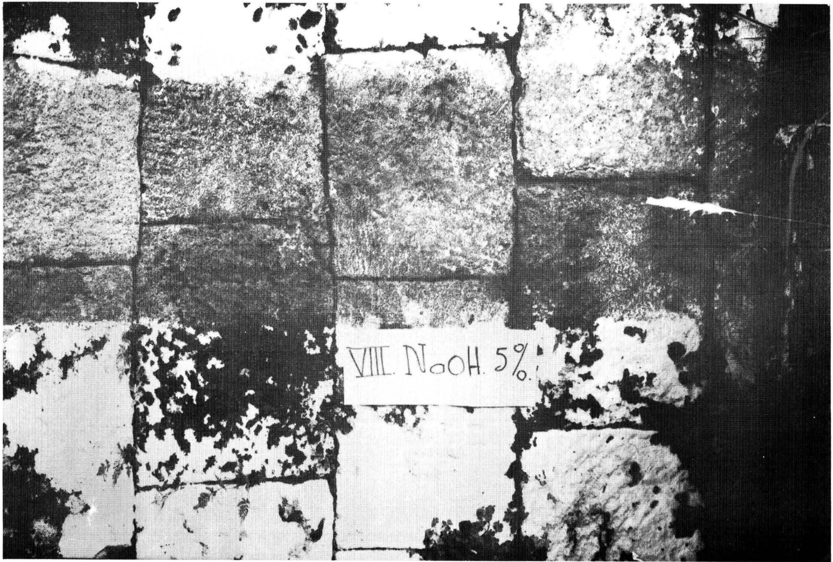
22. Percobaan membersihkan batu dengan bahan kimia. Foto ProBo 7726.
