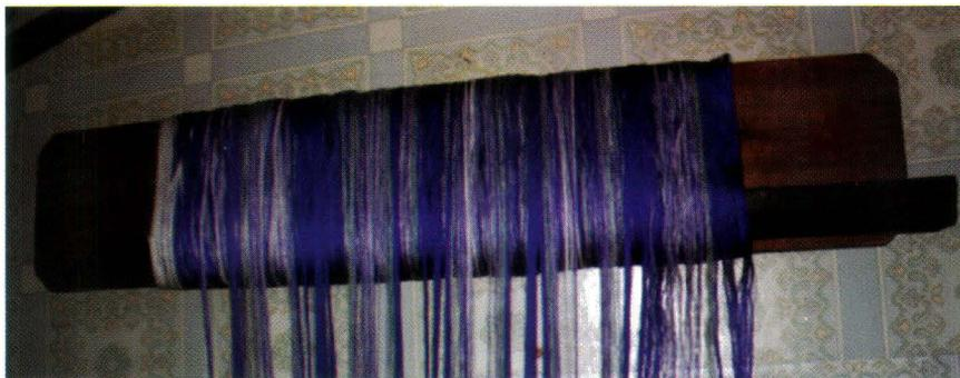
**Gambar 14:** *Pamalu* adalah tempat menggulung benang yang terbuat dari kayu/papan berukuran 100 x 15 x 2 cm. (Dok, 2009)
