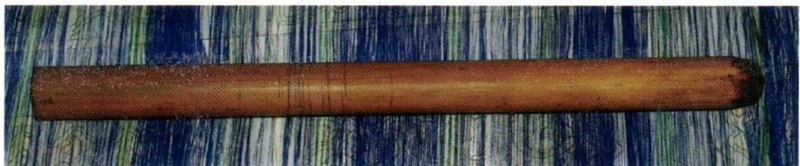
**Gambar 24:** *Taropong*, berfungsi sebagai sekoci pada mesin jahit. *Taropong* dibuat dari bambu dengan ukuran panjang 20 cm dan garis tengahnya 3,5 cm. (Dok, 2009)
