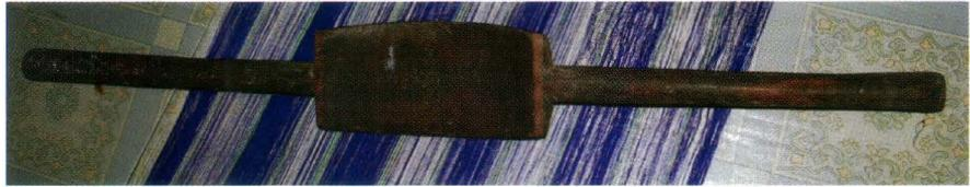
**Gambar 21:** *Boko-Boko*, dibuat dari kayu dan dibentuk sedemikian rupa, alat ini berfungsi sebagai alat pengikat tubuh pada bagian belakang/punggung si penenun pada waktu menenun. (Dok, 2009)
