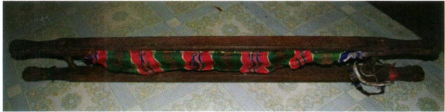
**Gambar 22:** *Pessa*, berfungsi sebagai tempat menggulung kain yang sudah selesai ditenun, dibuat dari kayu. Ujung kedua *Pessa* dihubungkan dengan kedua *Boko-Boko*, menggunakan alat tali pada kedua tepi yang sudah disediakan, yang disebut dengan *Ulang*. (Dok, 2009)
