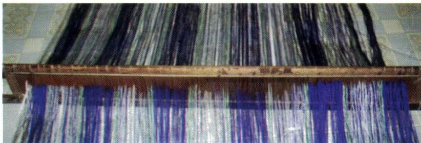
**Gambar 15:** *Sisir (Jakka)* alat ini berfungsi sebagai tempat untuk memasukkan benang. (Dok, 2009)
