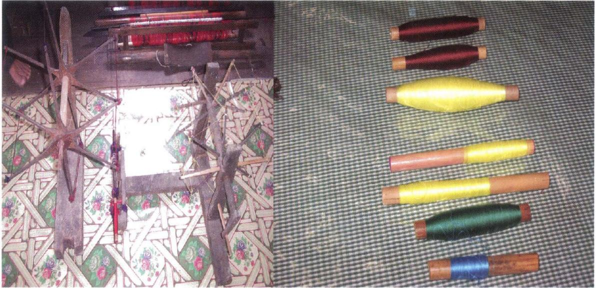
**Gambar 4:** (a) Alat pemintal benang; (b) Gulungan benang-benang yang sudah dipintal dalam bulo-bulo. (Dok, 2009)
