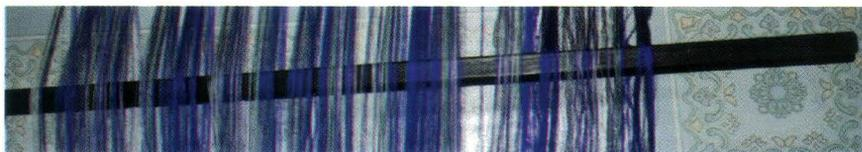
**Gambar 16:** *Palapa*, alat ini berfungsi sebagai penahan *awereng*, terbuat dari kayu ulin dan berukuran 105 x 2½ x 0,2 cm. (Dok, 2009)
