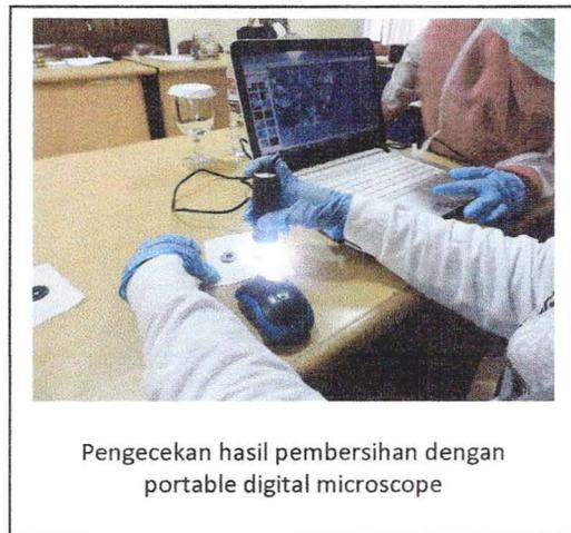
Pengecekan hasil pembersihan dengan portable digital microscope
