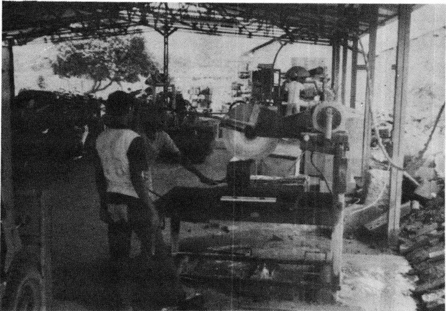
Pembuatan batu pengganti dengan mesin gergaji batu.
