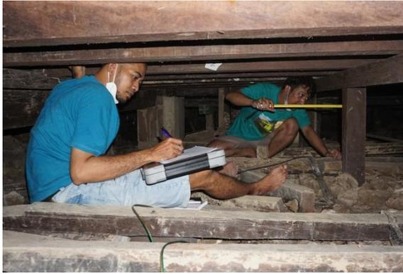
Foto 13. Pengukuran gelagar, slop dan pondasi
