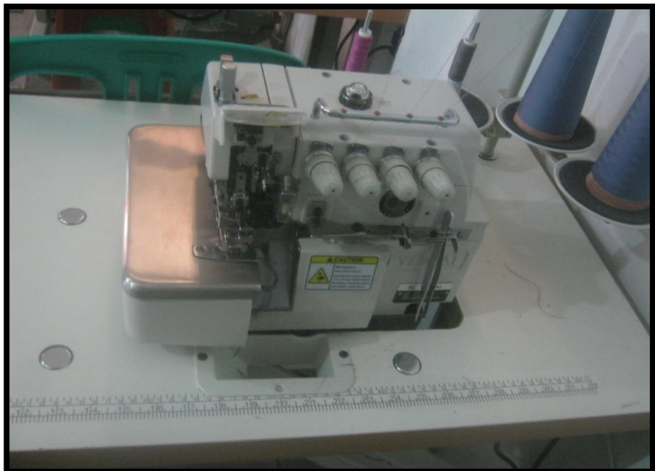
Gambar 1.8. Mesin Jahit Obras Benang 4
