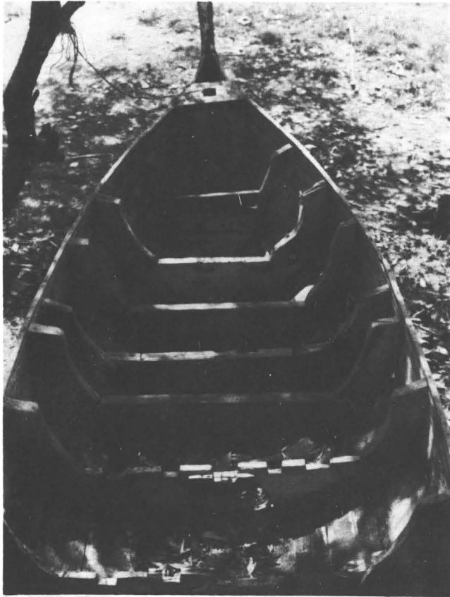
Foto 113. Persis di bawah gading-gading berbentuk huruf U, terletak secara membujur di bagian tengah sebuah lunas perahu.
