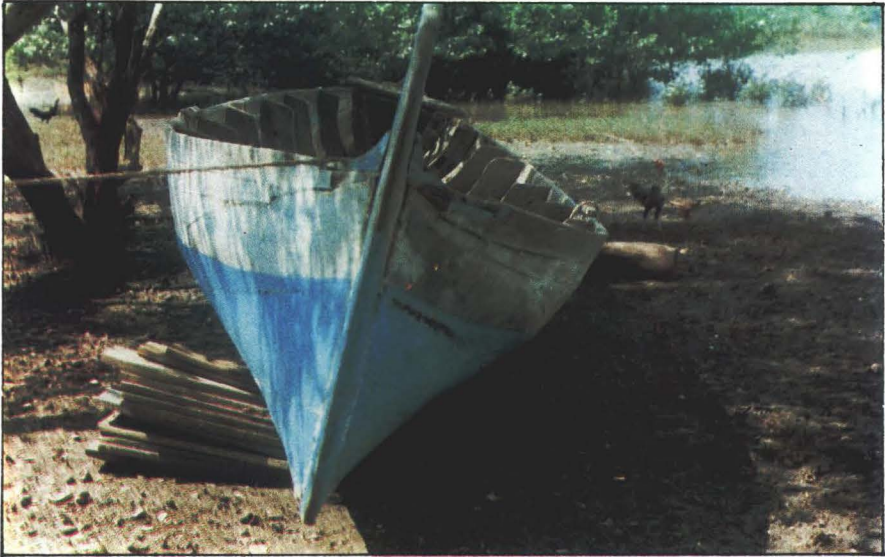
Foto 25. Bentuk badan dan kepala depan perahu sope. Kepala depan juga disebut linggi depan.
