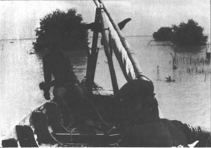
Foto 117. Sanggan layar dibuat terletak di bagian belakang perahu yang disebut buritan.
