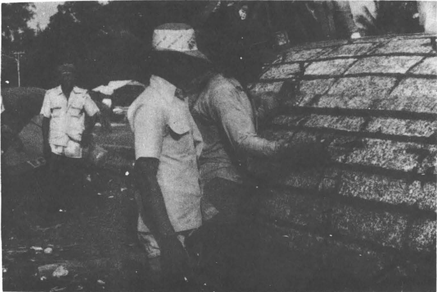
Foto 156. Cara pemeliharaan perahu sampan didempul dan dicat.
