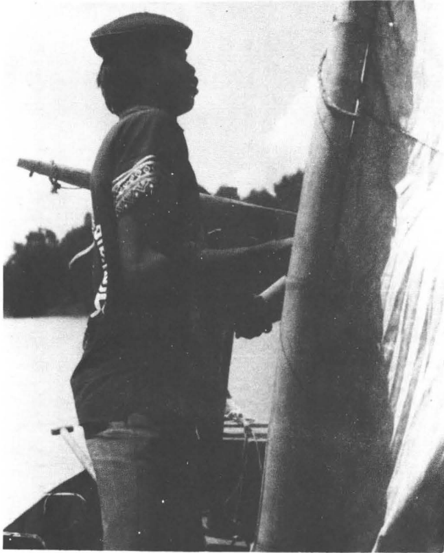
Foto 131. Bahan tiang layar pada perahu-perahu kecil dan sedang adalah bambu, dan lembaran layar terbuat dari kain blacu, tali-tali plastik.
