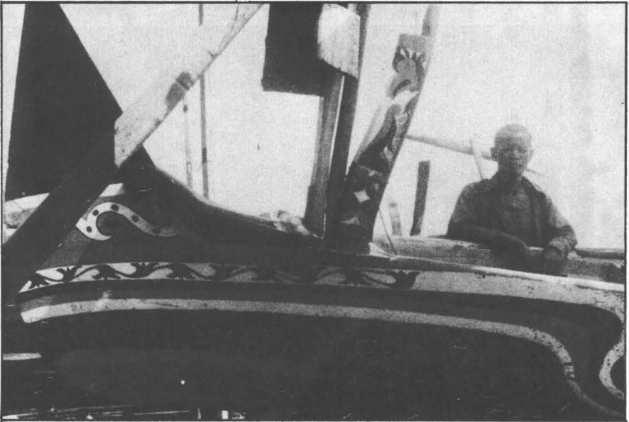
Foto 38. Linggi belakang perahu tembon. Kemudi dan sumbi-sumbi tempat gagang kemudi diletakkan.
