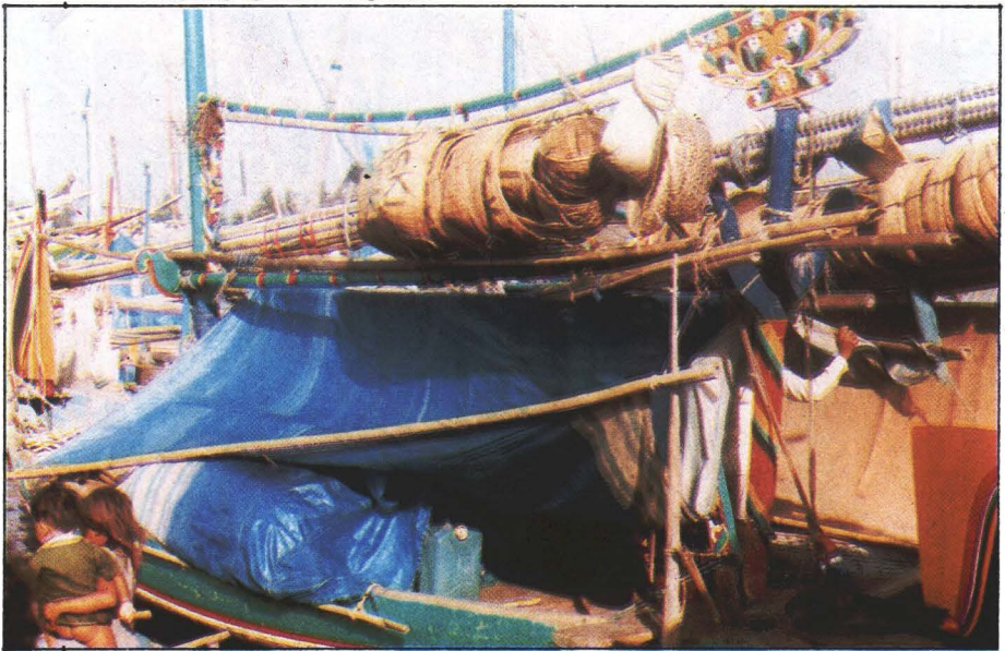
Foto 148. Bajing-bajing terletak di bagian tengah tiang layar (kiri). Bajing-bajing di bagian atas dari sanggan layar (kanan).
