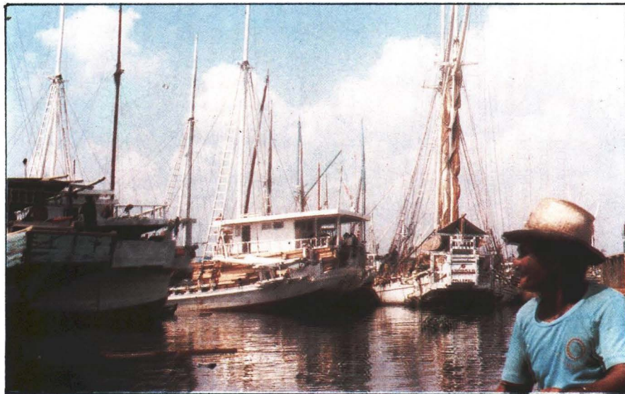
Foto 12. Perahu lambo – Bugis Makassar ukuran 3 – 30 ton bertiang layar 1 tiang agung. Perahu niaga. Terlihat bagian buritan. Pangkalan Pelabuhan Sunda Kelapa di Jakarta.
