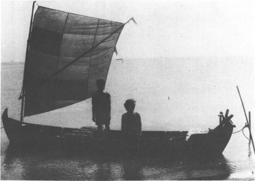
Foto 135. Letak dan bentuk layar perahu jenis sope.
