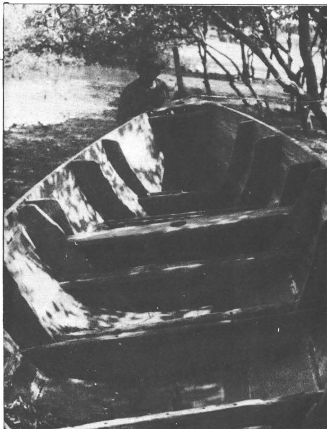
Foto 112. Gading-gading menentukan ukuran besar dan bentuk perahu.
