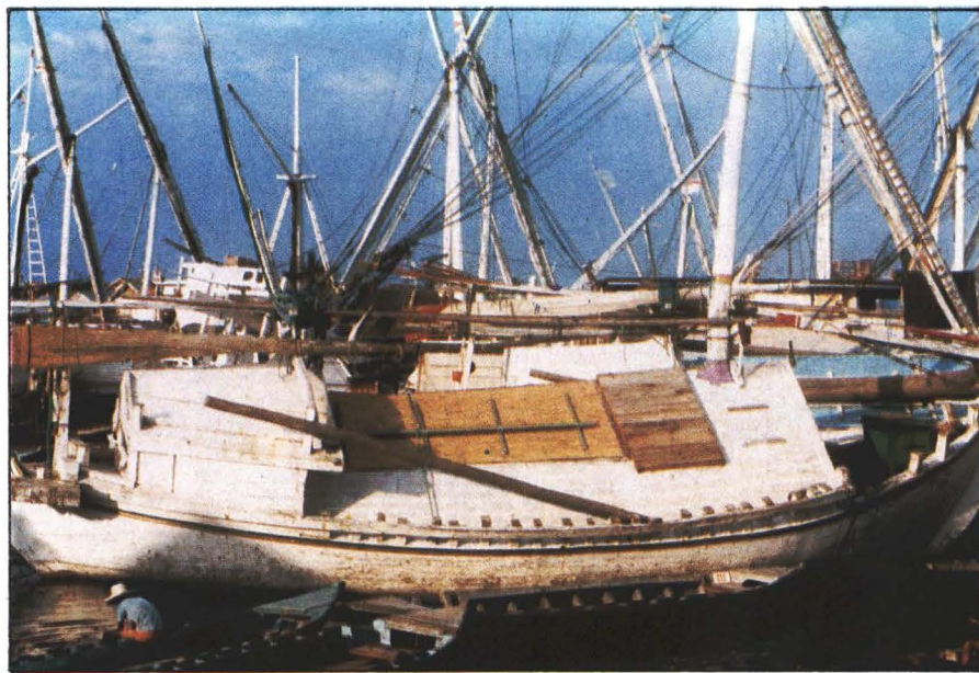
Foto 175. Perahu lete mempunyai pondok tetap yang disebut magun = kamar untuk melindungi barang-barang niaga berupa hasil bumi.
