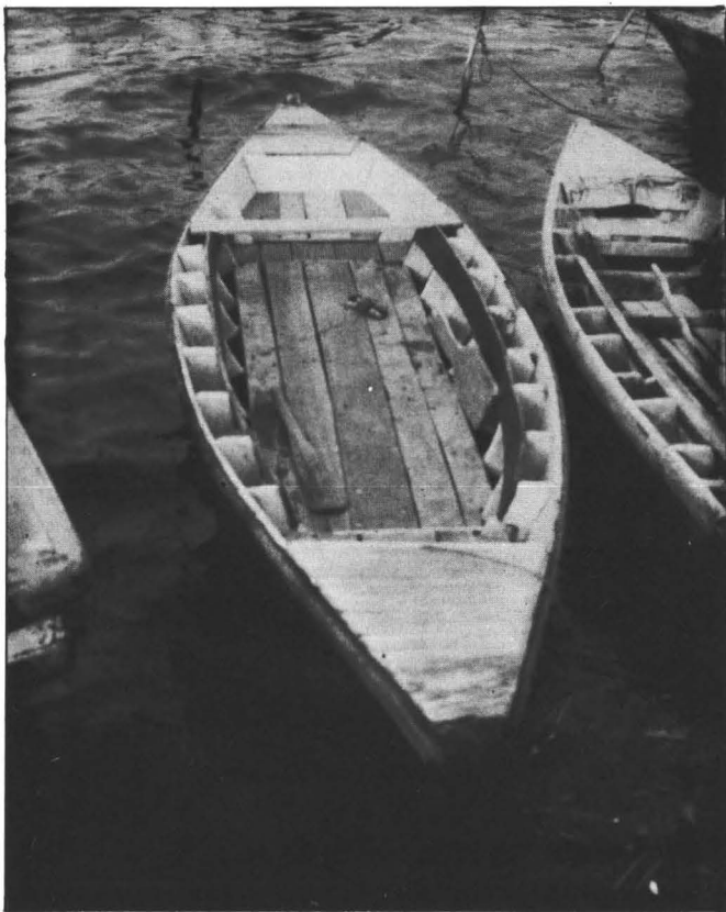
Foto 15. Sampan – jenis sampan pengangkut barang dan penumpang jarak dekat di sungai atau di teluk yang tidak bergelombang.
