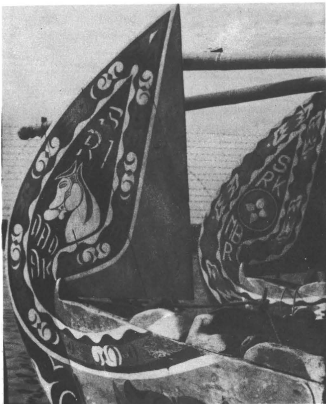
Foto 119. Linggi adalah bagian yang ditinggikan pada haluan maupun buritan sebuah perahu. Linggi juga disebut kepala perahu. Linggi depan = kepala depan. Linggi belakang = kepala belakang.
