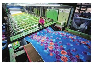
Proses pencetakan kain ini dimana pewarna diterapkan dengan cara melewatkan kain ke media cetak desain yang diukir (di-engraving) pada rol mesin cetak. Kemudian kain hasil produksinya dijual secara gulungan/roll kain. Keuntungan
