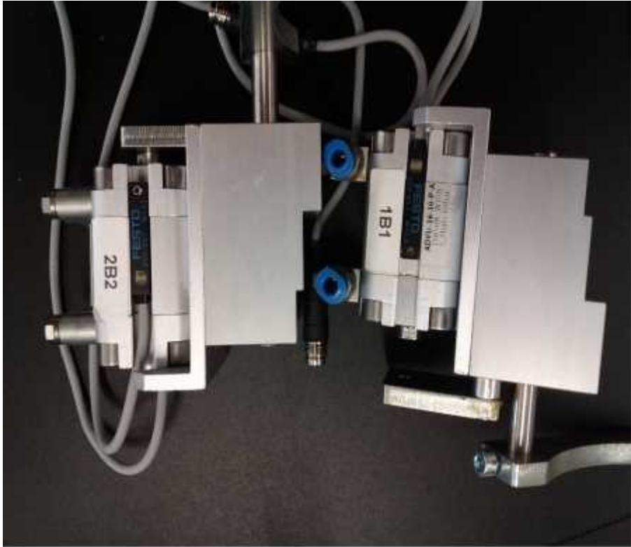
Gambar 2.5 Silinder kerja ganda
