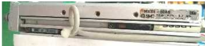
Gambar 2. 13 Sensor Pada Silinder Selection Atau Naik Turun
