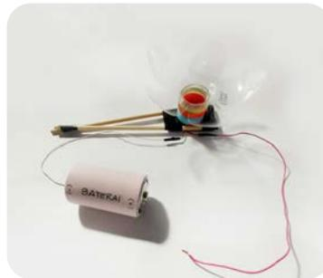
8. Jika ingin mencoba membuat kipas angin, pasang baling-baling kipas angin. Pegang atau tegakkan penyangga baling-baling. Tempelkan ujung kabel positif ke bagian atas baterai (positif). Baling-baling akan berputar. Rasakan angin yang dihasilkan baling-baling itu.
