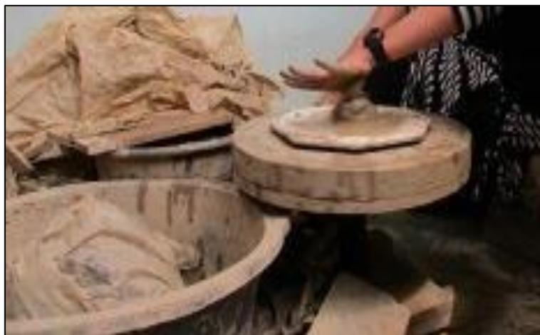
Gambar 57. Meletakkan Tanah Liat Di Meja Putar
