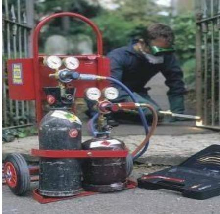
Gambar 55. Las Karbit untuk metal
