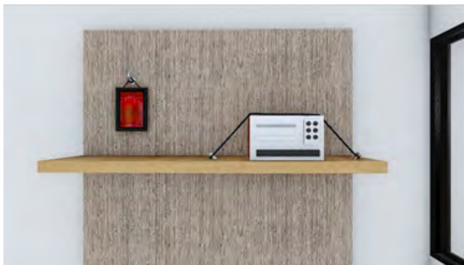
Gambar 7. Komponen non-struktur harus diberi pengaku.
