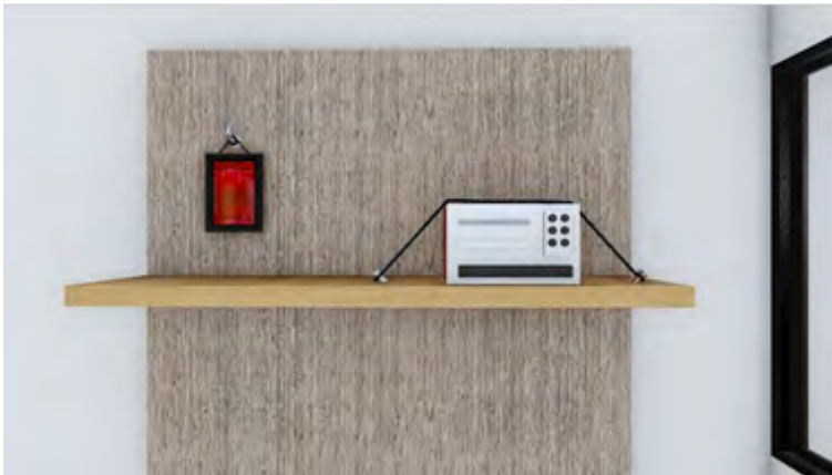
Gambar 7. Komponen non-struktur harus diberi pengaku
