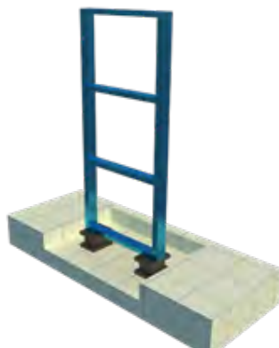
Gambar 8. Ilustrasi struktur yang diberikan isolation bearing
