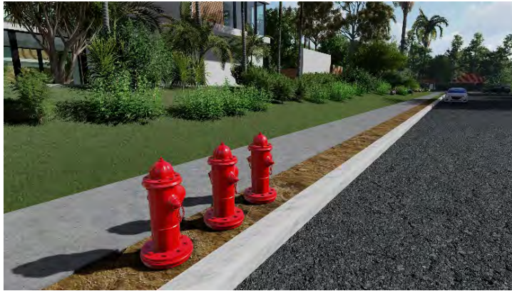
Gambar 9. Ilustrasi penempatan pipa hydrant di jalan
