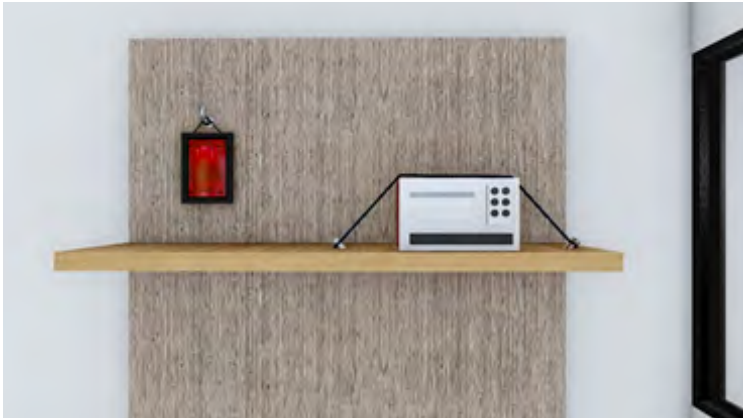
Gambar 7. Komponen non-struktur harus diberi pengaku
