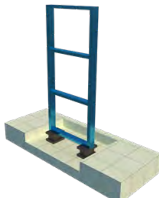
Gambar 8. Ilustrasi struktur yang diberikan isolation bearing
