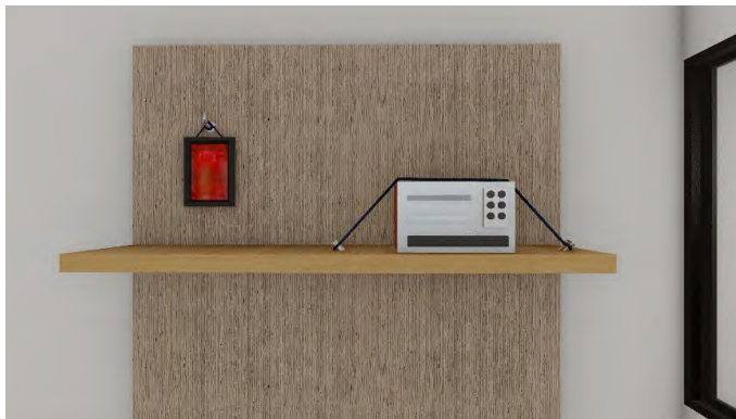
Gambar 7. Komponen non-struktur harus diberi pengaku
