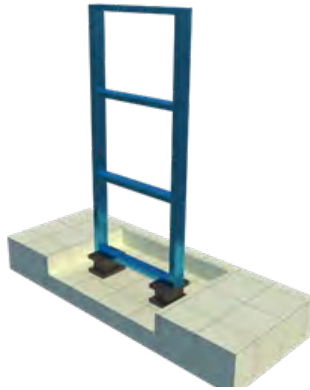
Gambar 8. Ilustrasi struktur yang diberikan isolation bearing
