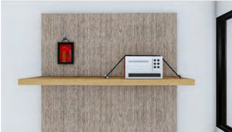
Gambar 7. Komponen non-struktur harus diberi pengaku
