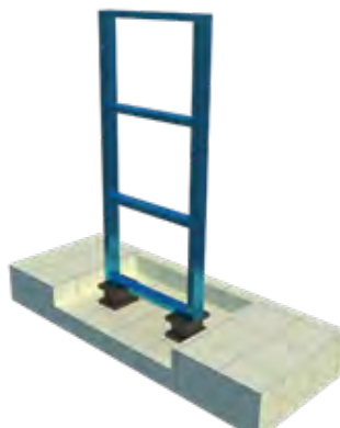
Gambar 8. Ilustrasi struktur yang diberikan isolation bearing
