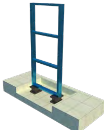
Gambar 8. Ilustrasi struktur yang diberikan isolation bearing
