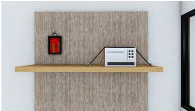
Gambar 7. Komponen non-struktur harus diberi pengaku
