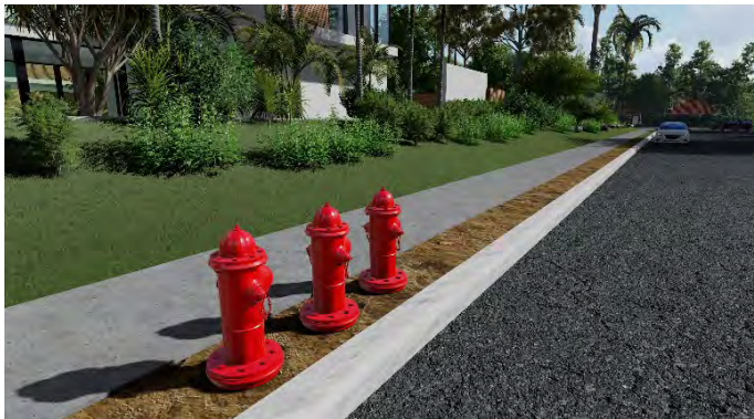
Gambar 9. Ilustrasi penempatan pipa hydrant di jalan
