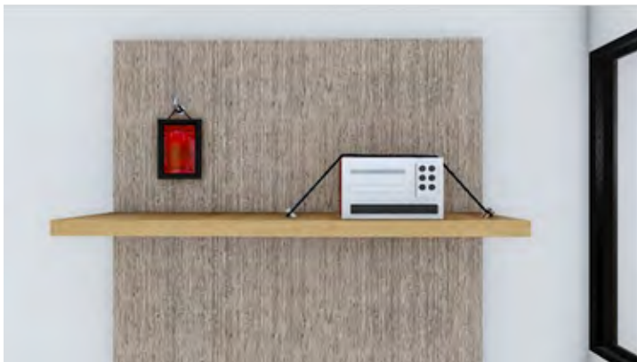
Gambar 7. Komponen non-struktur harus diberi pengaku
