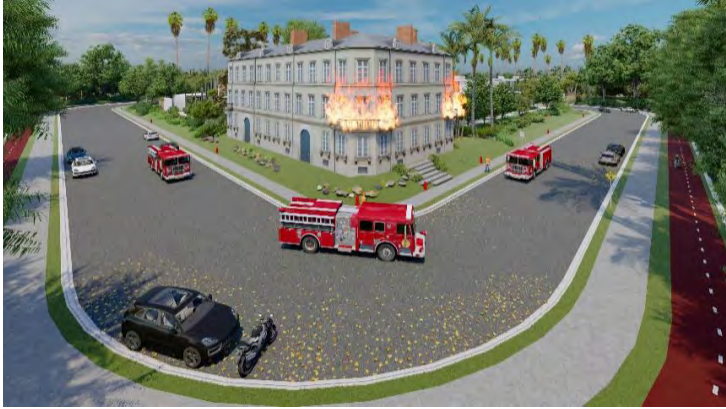
Gambar 16. Ilustrasi akses jalan untuk mobil pemadam kebakaran
